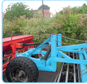
Transport chassis with seeder hoist / das Fahrgestell mit oder ohne Hydropack / chariot de transport
