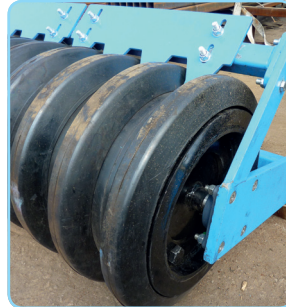
Rubber roller \phi 500 mm / Gummiwalze \phi 500 mm / Rouleau en caoutchouc \phi 500 mm
