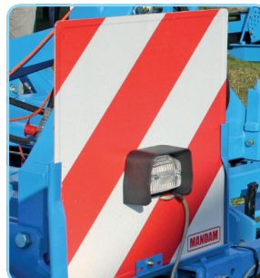
Transport lights / Beleuchtungsalge mit Warntafel / Eclairge de route
