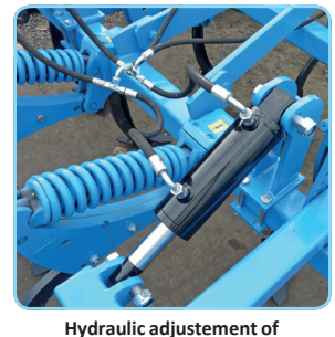
Hydraulic adjustment of working depth / die hydraulische einstellung der Arbeitstiefe / Reglage hydraulique de la profondeur de travail
